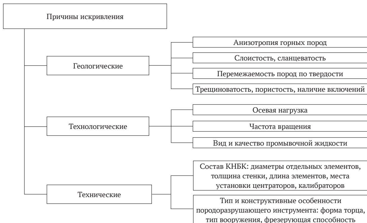
Рис. 83. Причины естественного искривления скважин [ppt-online.org]
