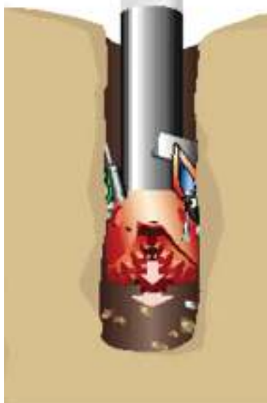
Рис. 80. Прихват бурового инструмента металлическими обломками [present5.com]
