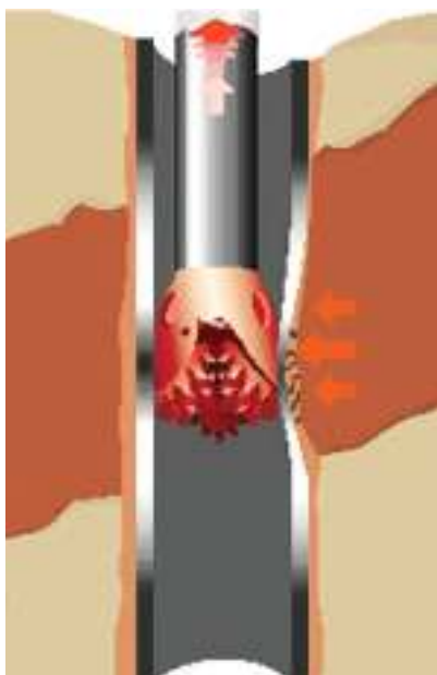
Рис. 79. Прихват долота, вызванный смятием ОК [present5.com]
