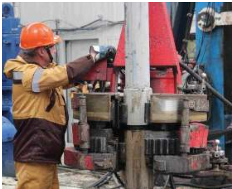
Рис. 38. Автоматический буровой ключ (АКБ) для навинчивания и развинчивания труб [mopo.lukoil.ru]
