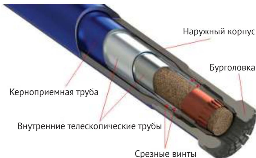
Рис. 54. Снаряд для отбора керна [burintekh.ru]
